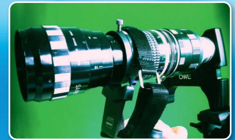
Für Fortgeschrittene: Filmeinheit bestehend aus OWLE, EnCinema-Adapter und anamorphotischem Objektiv.
